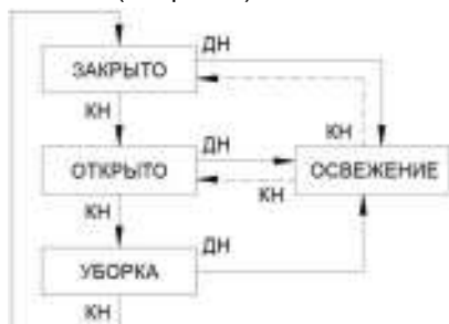
Рисунок 2 - схема управления модулем с помощью кнопки. КН - короткое нажатие, ДН - длительное нажатие.
