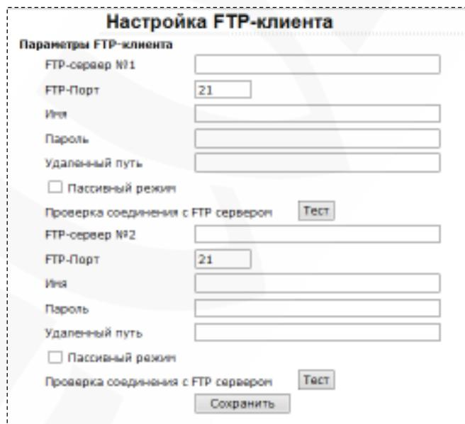
Отправка уведомлений и статических картинок на FTP-сервер может осуществляться при возникновении тревожного события: детекция движения, заслон/засветка. Отправка выполняется по протоколу FTP. Возможно настроить отправку сразу на два FTP-сервера.
