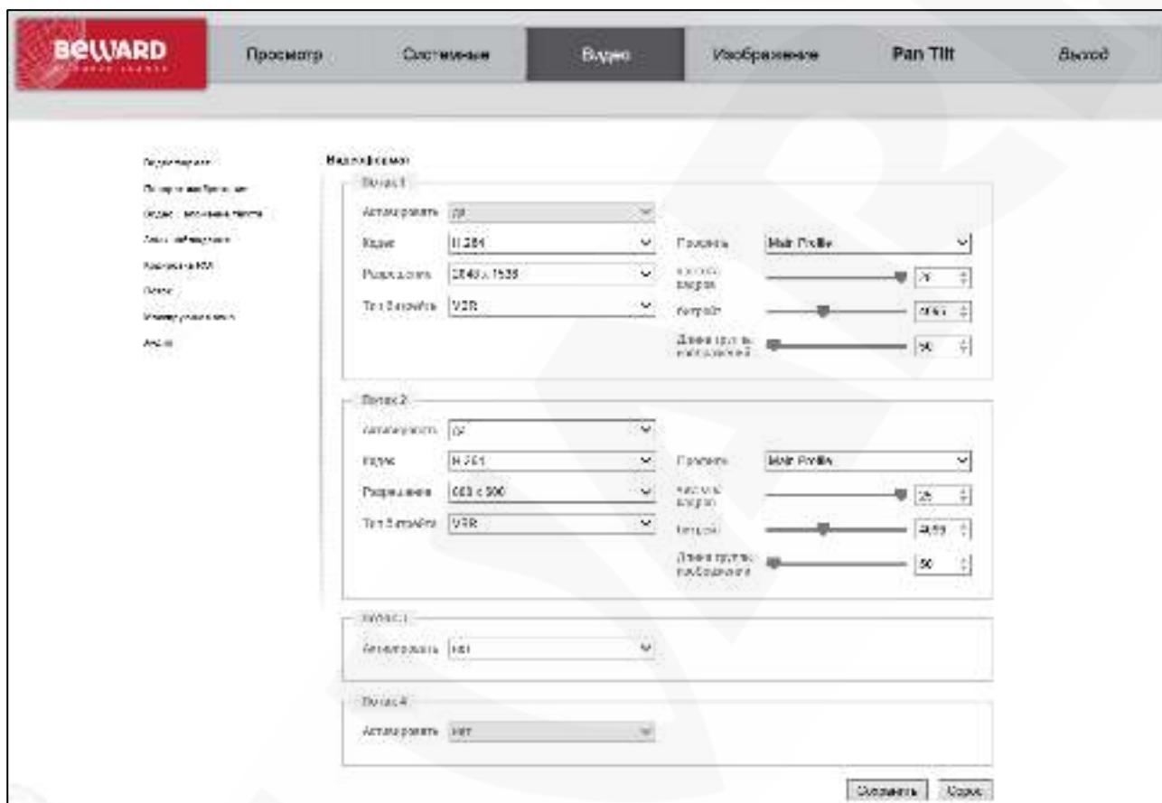
**Кодек (Encode Type):** В качестве форматов кодирования могут быть выбраны MJPEG, H.264 и H.265.
