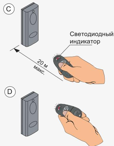
**ВНИМАНИЕ!** Каждое последующее нажатие кнопки (при программировании нескольких брелков-передатчиков) должно производиться в течение интервала времени не более 20 секунд после предыдущего, иначе процедура программирования прерывается.
