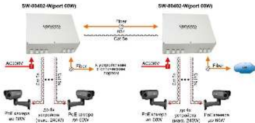
Рис.6 Типовая схема подключения коммутатора SW-80402-W(port 60W)
