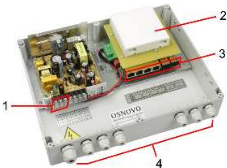
Рис.2 Коммутатор SW-80402-W(port 60W), вид внутри
