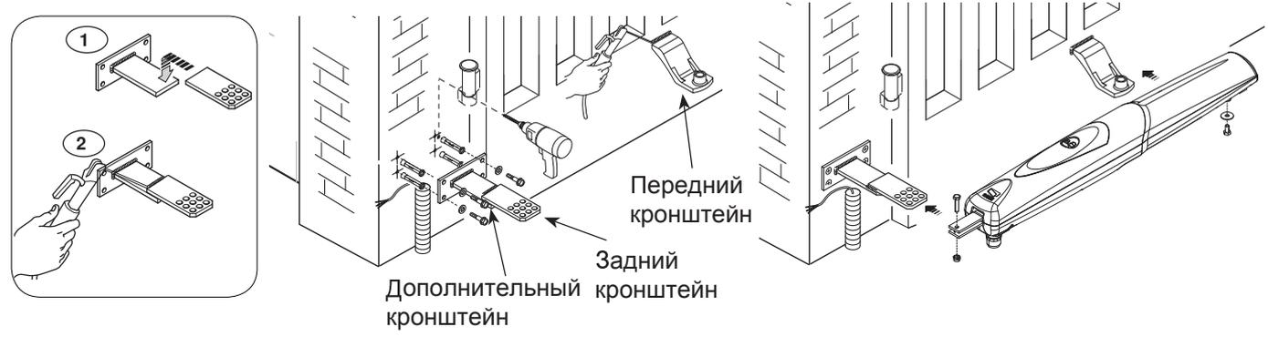
Привод AX5024: закрепите прилагаемый кронштейн к столбу, без дополнительных кронштейнов, выдерживая размеры, указанные в таблице 2. Установите привод на кронштейны и закрепите его с помощью прилагаемых болтов и шайб.
