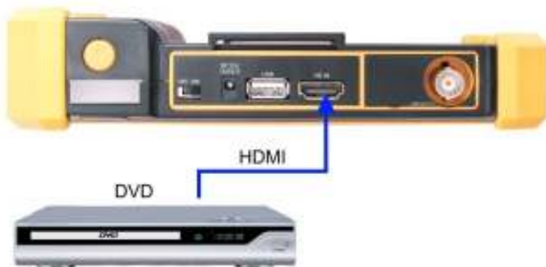
Рис. 13 Подключение HDMI устройств к тестеру.
