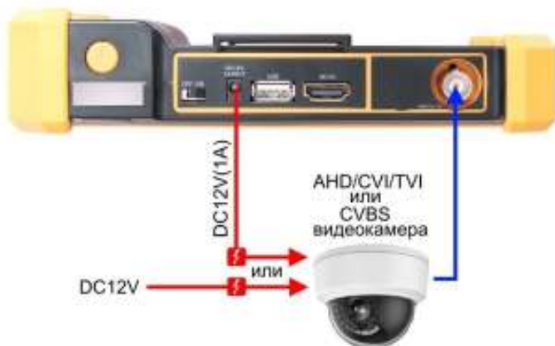
Рис. 7 Подключение CVBS или AHD/TVI/CVI видеокамеры к тестеру
