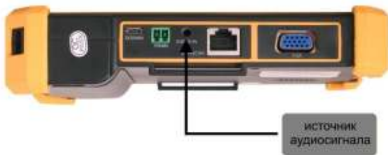
Рис. 19 Подключение источника аудиосигнала к тестеру
