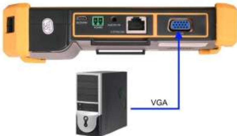
Рис. 14 Подключение устройств к VGA входу тестера
