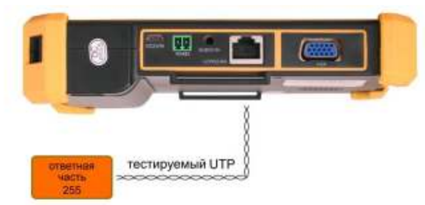
Рис.15 Подключение тестируемого кабеля
