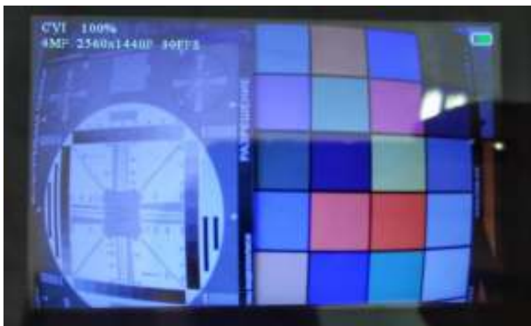
Рис. 8 Изображение с видеокамеры на экране тестера TSH-H-5
