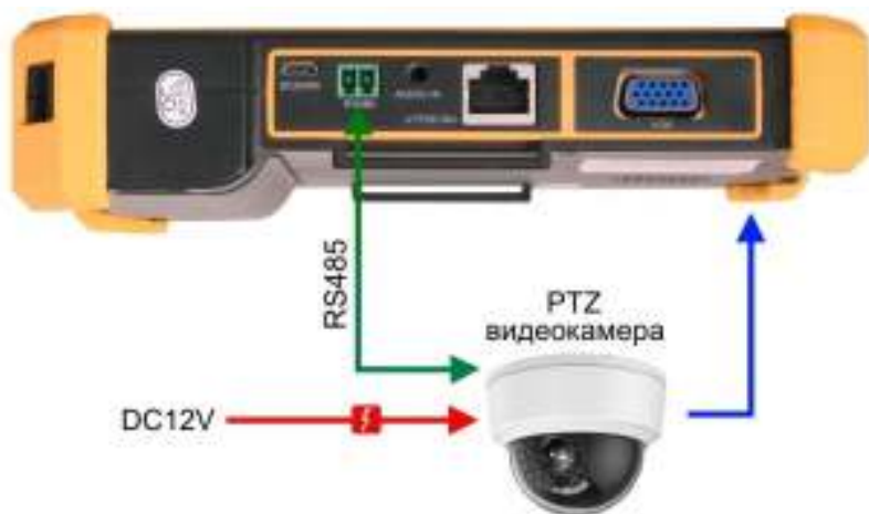
Рис. 9 Подключение PTZ видеокамеры к тестеру
