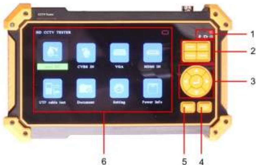
Рис. 3 Тестер TSH-H-5, кнопки и индикаторы передней панели
