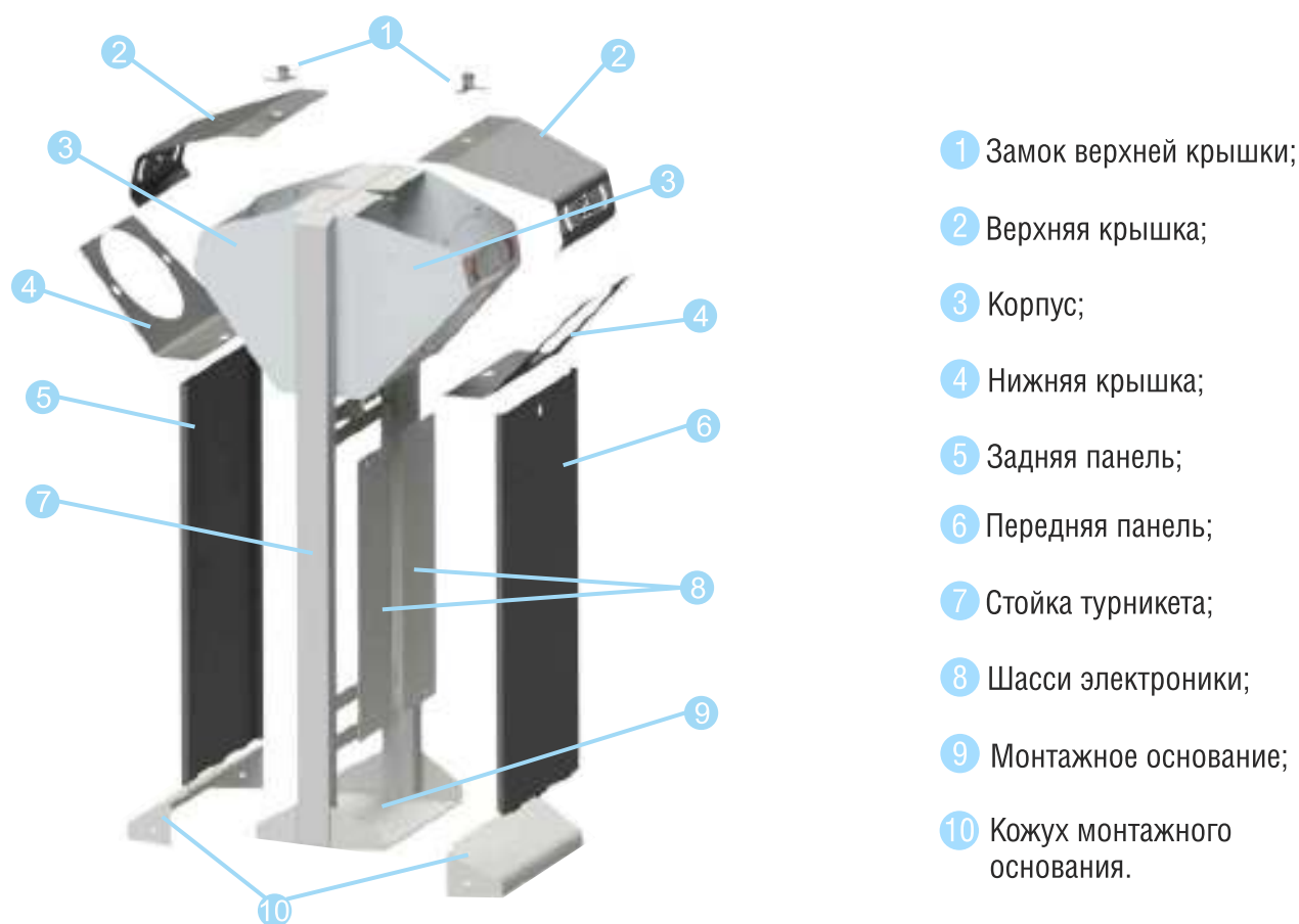
Рисунок 6.1.1 Устройство корпуса турникета
