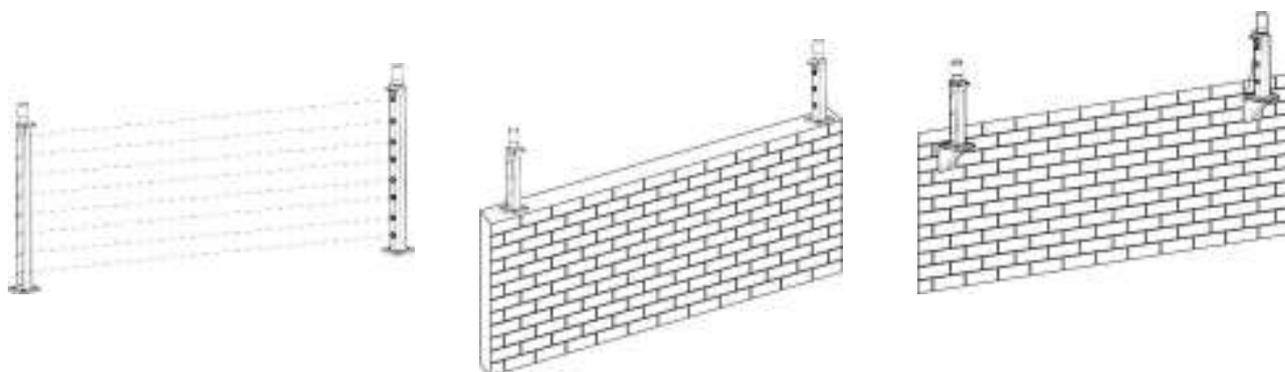
Перед монтажом убедитесь в правильности выбранной позиции, затем сделайте разметку и просверлите отверстия для установки анкеров, в заключение вставьте в просверленные отверстия анкера и затяните их.
