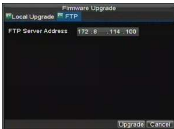
Рис. 12. Обновление устройства через FTP сервер
