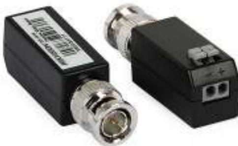
Экономичное и надёжное решение передачи видеосигнала по "витой паре" представлено пассивным одноканальным приёмодередатчиком DS-1H18. Устройство предназначено для преобразования ассиметричного композитного видеосигнала с волновым сопротивлением 75 Ом в симметричный, для передачи его по кабелю "витая пара" на большие расстояния. В комплект поставки входит 2 приемопередатчика.
