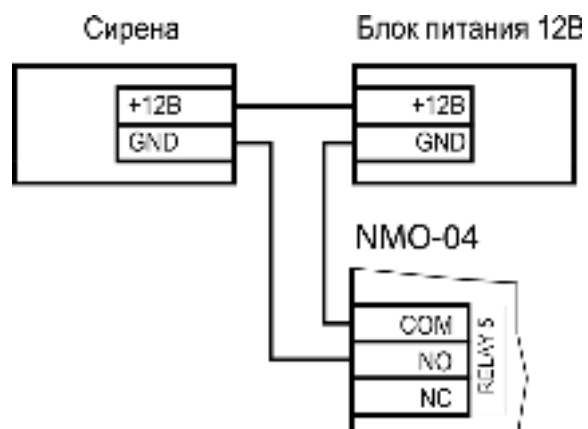
Рисунок 2. Подключение сирены к выходу реле
