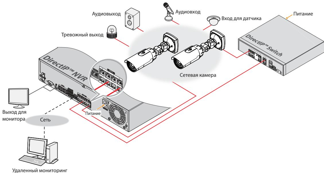
Сетевой видеорегистратор с протоколом DirectIP™ позволяет легко использовать камеры без дополнительных сетевых конфигураций.
