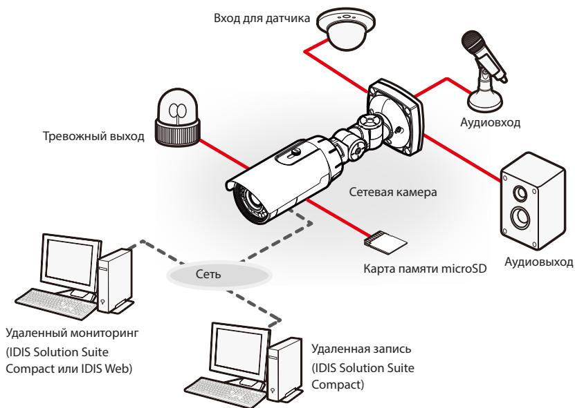
Управляет камерой по сети через программное обеспечение, установленное на компьютере.
