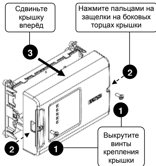
Рисунок 2. Снятие крышки контроллера
