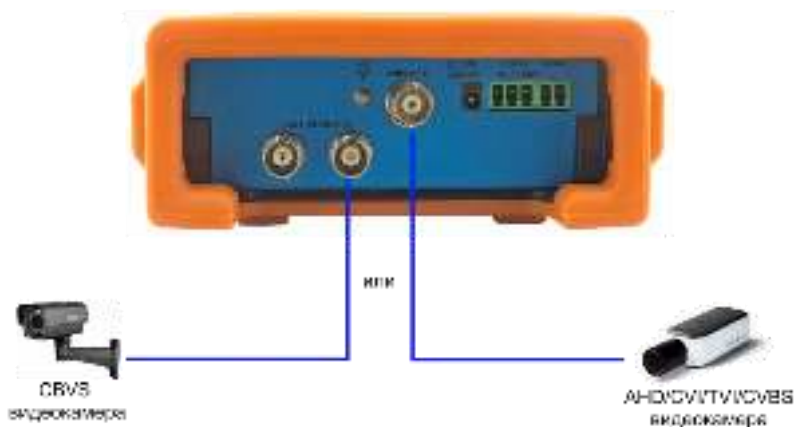
Рис.2 Разъемы для подключения AHD/CVI/TVI и CVBS видеокамер
