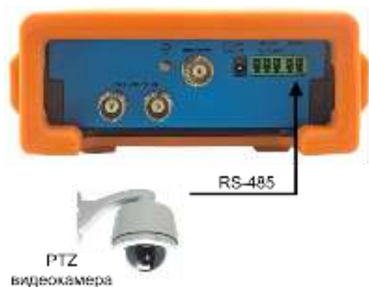
Рис.7 Подключение управляемой PTZ видеокамеры к тестеру
