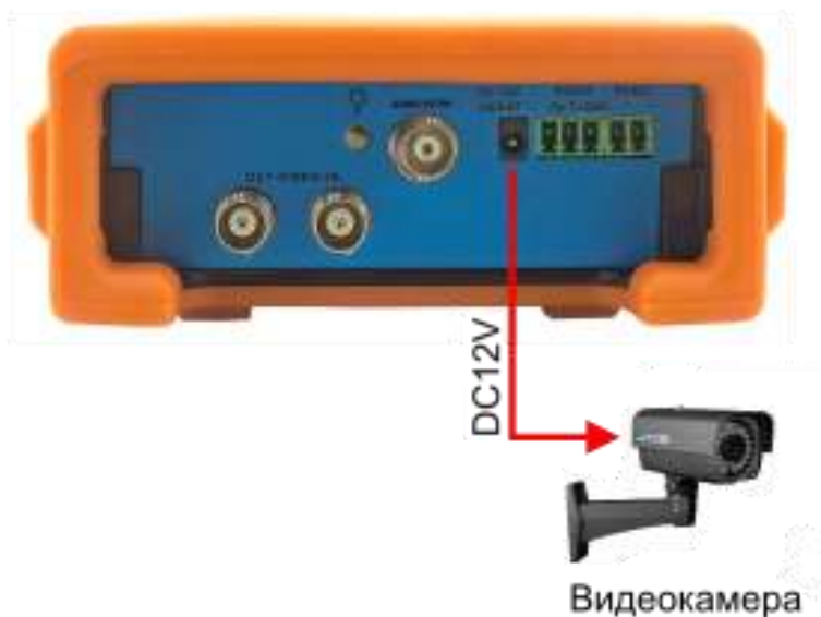
Рис. 4 Подключение питания DC 12V к видеокамере от тестера
