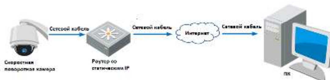
Рисунок 2-10 Доступ к камере через роутер со статическим IP-адресом
