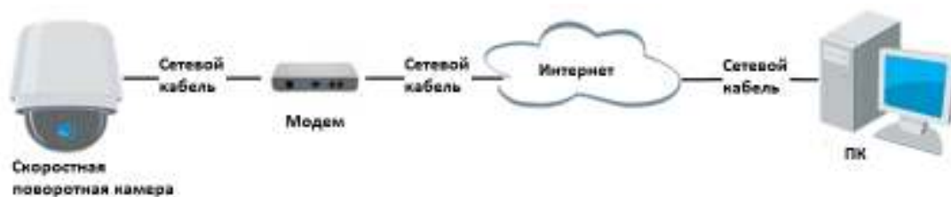
Рисунок 2-12 Доступ к камере с динамическим IP-адресом
