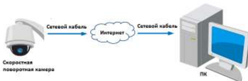
Рисунок 2-11 Доступ напрямую к камере со статическим IP-адресом
