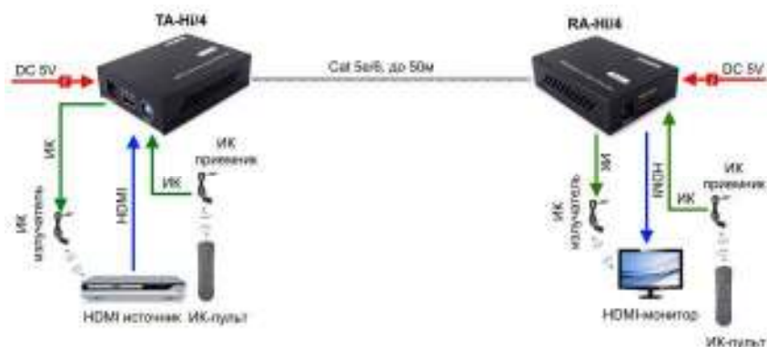
Рис. 8 Схема подключения TA-Hi/4 + RA-Hi/4
