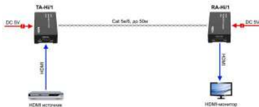
Рис. 7 Схема подключения TA-Hi/1 + RA-Hi/1
