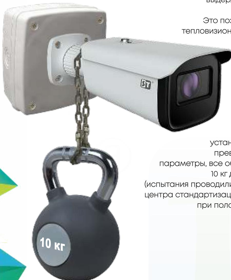
При тестировании мы устанавливали груз во много раз превосходящий рекомендуемые параметры, все образцы выдержали нагрузку 10 кг даже при температуре  $-35^{\circ}\text{C}$  (испытания проводились в климатической камере центра стандартизации, метрологии и испытаний при положительных и отрицательных температурах).
