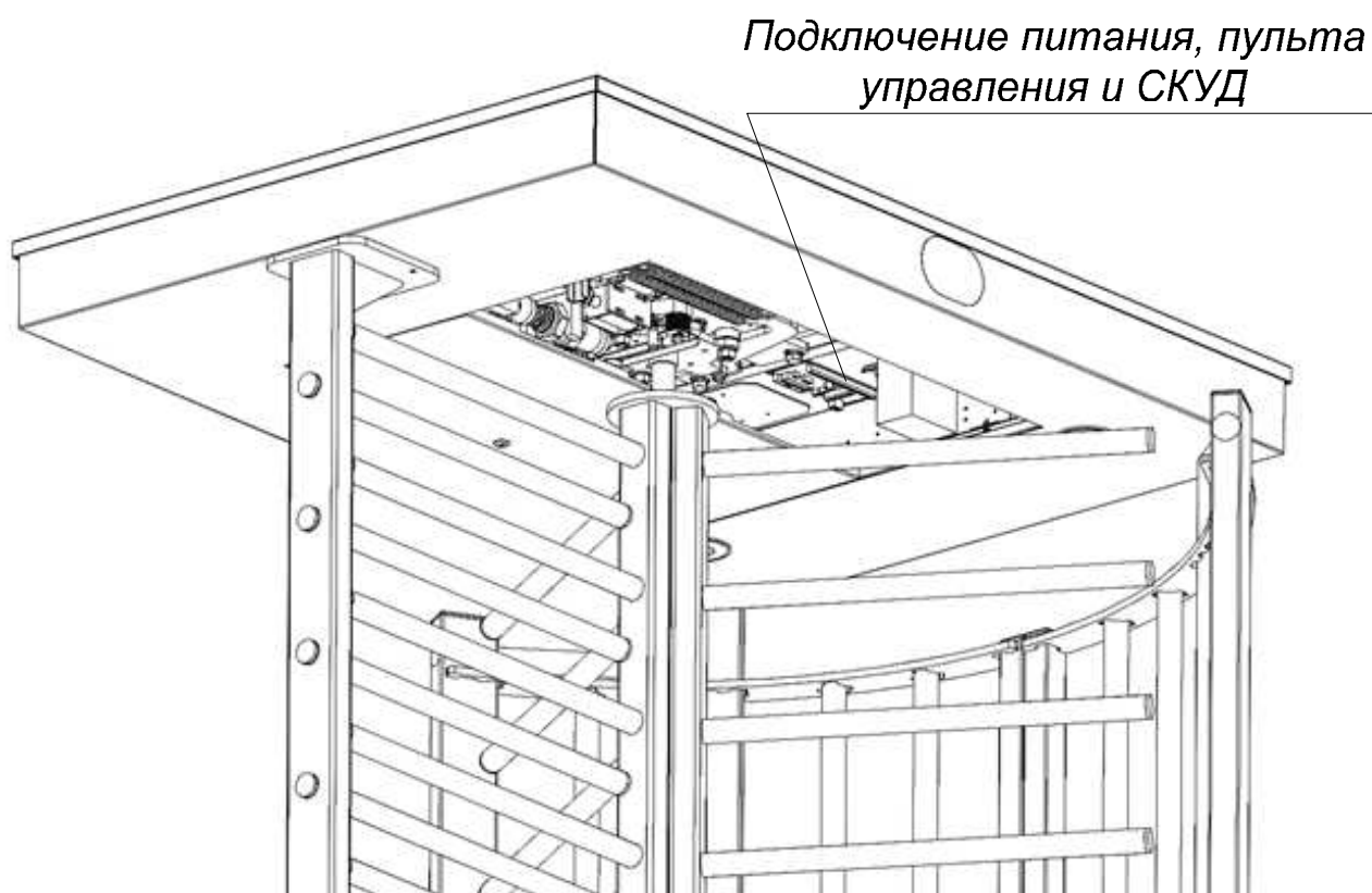
Рис. 15. Расположение кросс-платы на верхнем модуле турникета.
