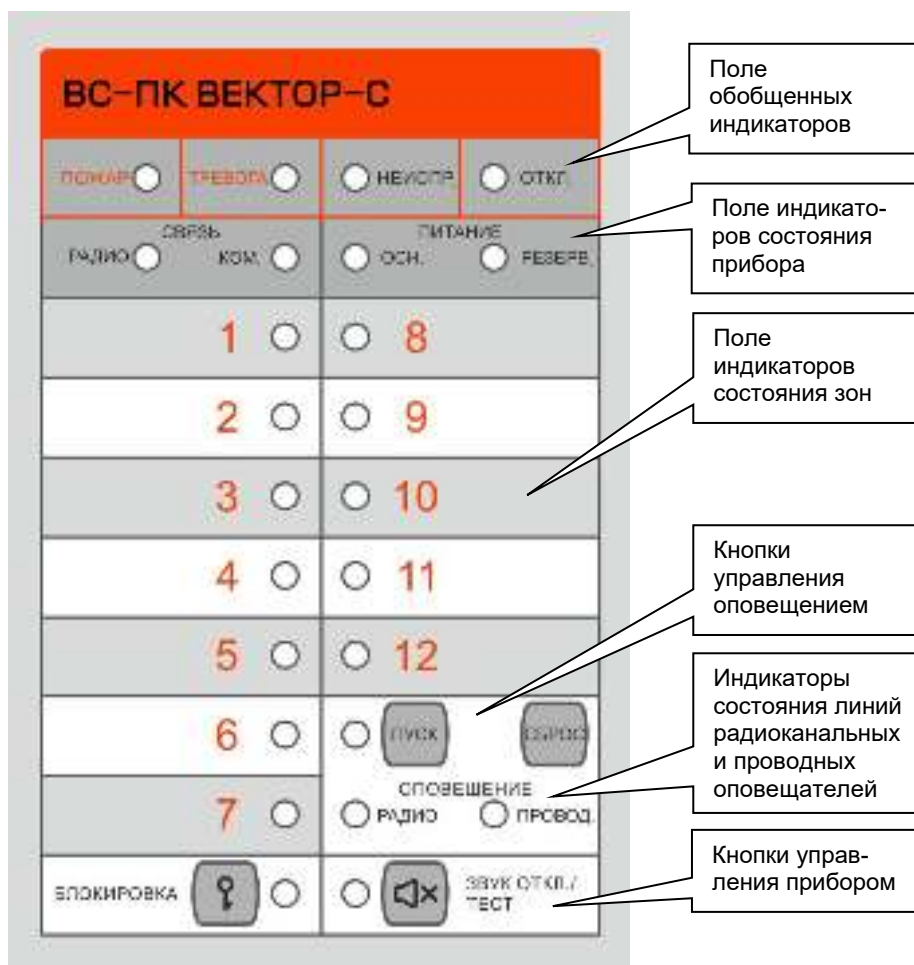
Рис.1. Внешний вид панели индикации и управления прибора.
