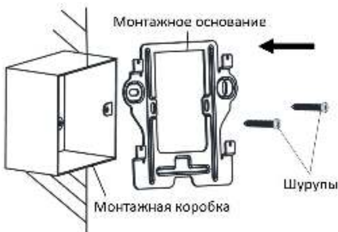
Рисунок 4-2 Установка монтажного основания
