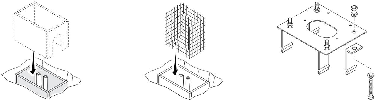
Установите монтажное основание поверх железной сетки.
