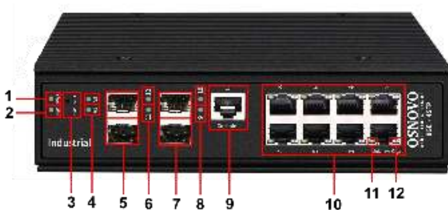
Рис.8 Коммутатор SW-70804/ILS, разъемы, кнопки и индикаторы на передней панели
