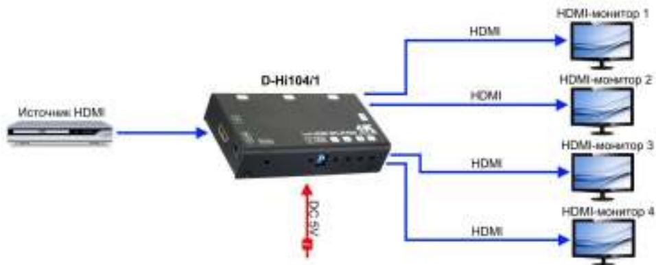
Рис.7 Типовая схема подключения разветвителя HDMI D-Hi104/1
