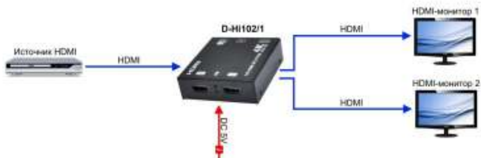
Рис.6 Типовая схема подключения разветвителя HDMI D-Hi102/1
