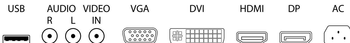
Рис. 1. Разъемы на задней панели монитора
