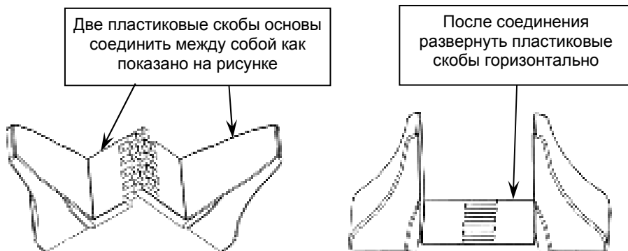
Рисунок 3 - Сборка пластиковых основ для вертикальной установки изделия.
