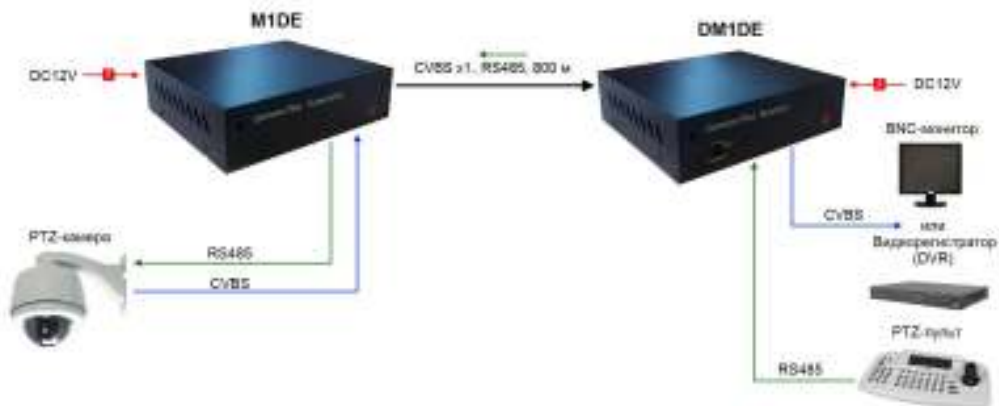
Рис. 6 Схема подключения передатчика M1DE и приёмника DM1DE.
