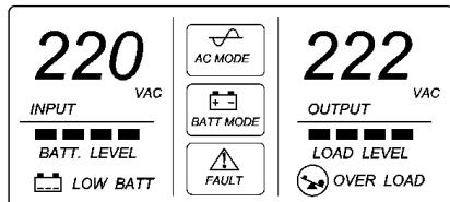
На дисплее отображается значение входного напряжения (INPUT), значение выходного напряжения (OUTPUT), уровень заряда АКБ (BATT LEVEL) и уровень нагрузки (LOAD LEVEL).
