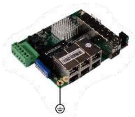
Рис.6 Заземление коммутатора SW-50602/I-P
