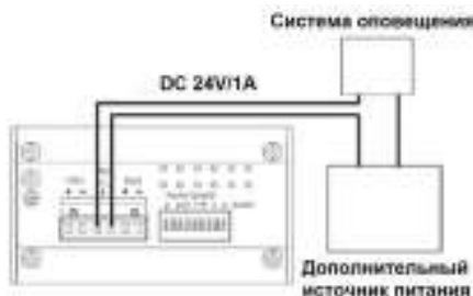
Рис.5 Схема подключения системы оповещения к коммутатору SW-50602/I-P.
