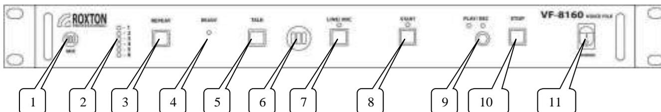
**1. Микрофон:** Встроенный высокочувствительный микрофон для оперативной записи сообщения без использования линейного входа блока.
