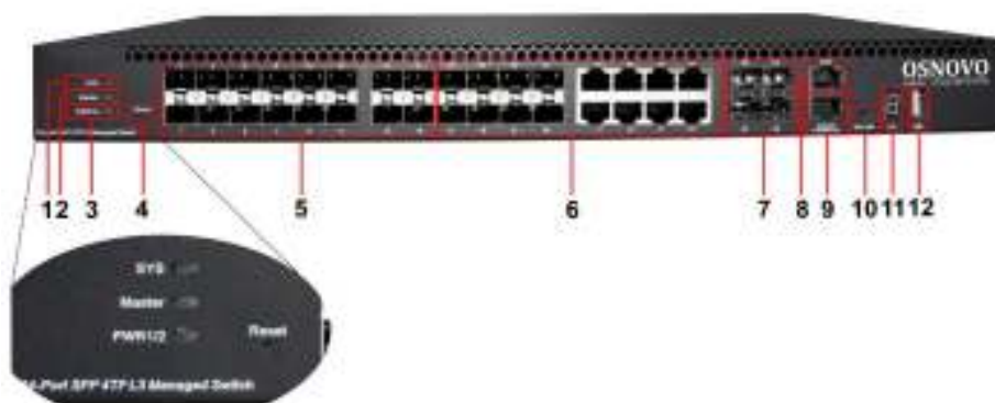
Рис.2 Коммутатор SW-32G4X-1L, разъемы, кнопки и индикаторы на передней панели
