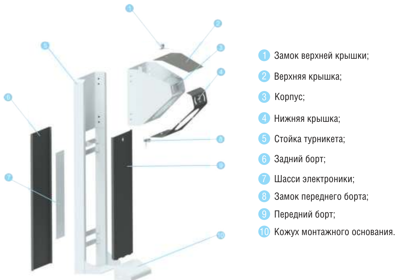
Рисунок 6.1.1 Устройство корпуса турникета
