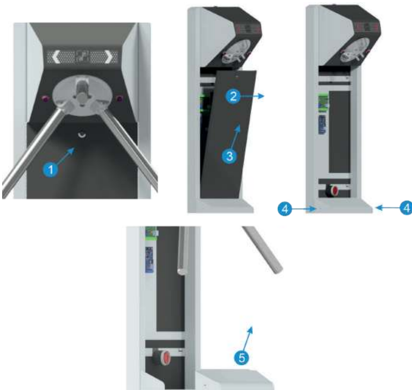
Рисунок 7.4.2 Частичная разборка корпуса турникета для монтажа
