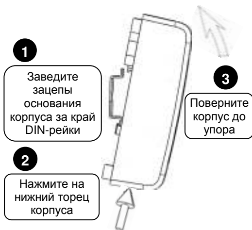
Рисунок 3. Крепление информатора на DIN-рейку
