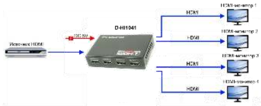
Рис.4 Типовая схема подключения HDMI разветвителя D-Hi1041
