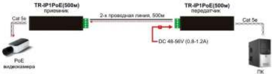
Рис.3 Типовая схема подключения удлинителя TR-IP1PoE(500м), передатчик работает как PoE инжектор
