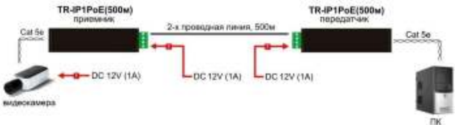
Рис.4 Схема подключения удлинителя TR-IP1PoE(500м) в режиме передачи данных, питание к устройствам подается отдельно
