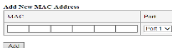
Рис. 5.3.22.2 Добавление нового MAC адреса и таблица MAC адресов
