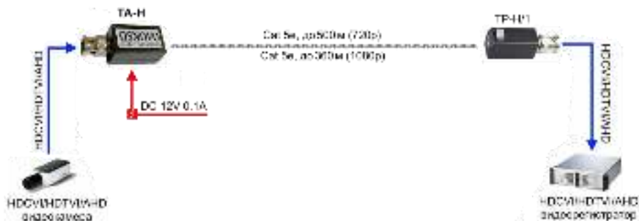
Рис.4 Типовая схема подключения активного передатчика TA-H и пассивного приемопередатчика TP-H/1
