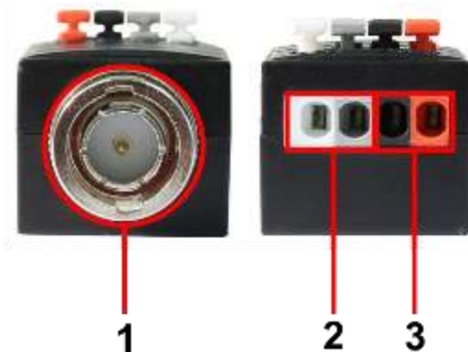
Рис. 2 Передатчик ТА-Н, разъемы спереди/сзади
