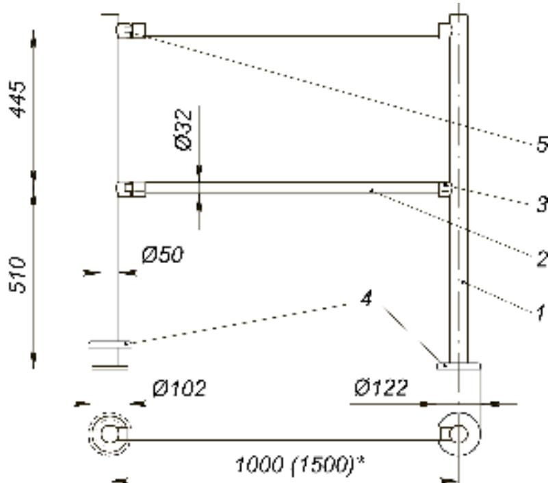
**Рисунок 4. Секция ограждения без заполнения с поворотными патрубками<sup>1</sup>:**
