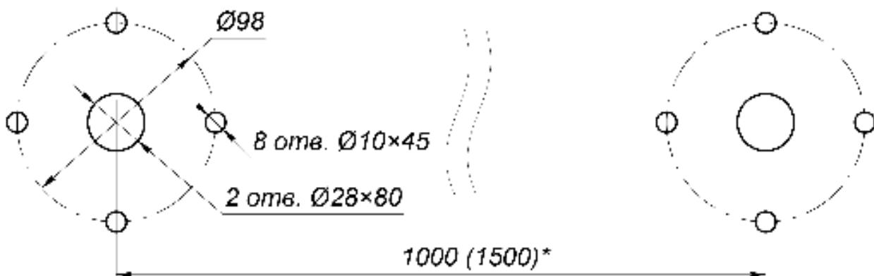
Рисунок 13. Схема разметки отверстий для установки фланцев быстросъемной секции ограждения<sup>1</sup>
