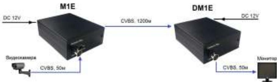
Рис. 7 Схема подключения передатчика M1E и приёмника DM1E.
