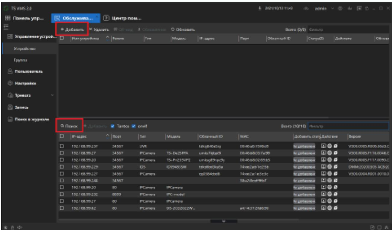
Для добавления устройств в локальной сети можете использовать как автопоиск (кнопка **Поиск**), так и добавление вручную (кнопка **Добавить**).
