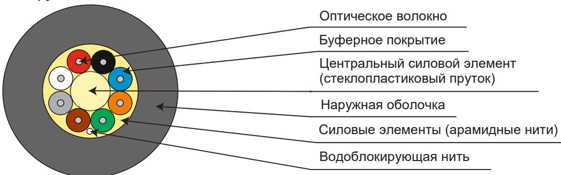
Кабель 2-4 ОВ содержит пучок оптических волокон в буферном покрытии и водоблокирующую нить, на которые наложен слой упрочняющих арамидных нитей с водоблокирующим эффектом. Кабель 8-24 ОВ содержит сердечник с центральным силовым элементом из диэлектрического стержня, вокруг которого скручены оптические волокна в буферном покрытии и водоблокирующая нить. На сердечник накладывается слой упрочняющих арамидных нитей с водоблокирующим эффектом.
