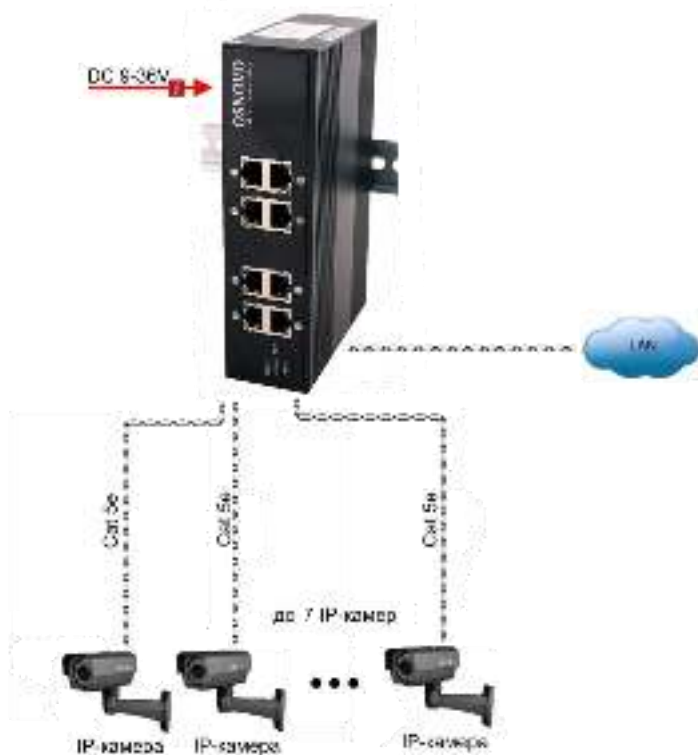
Рис.5 Типовая схема подключения коммутатора SW-70800/1
