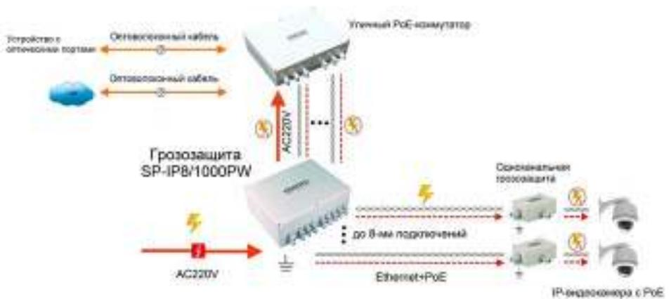
Рис.5 Подключение SP-IP8/1000PW.
