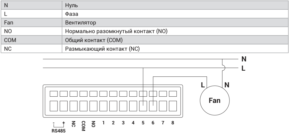
Рис. 2.2 Схема подключения интерфейса входа переменного тока
