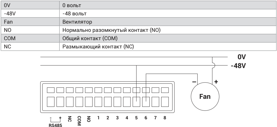
Рис. 2.3 Схема подключения интерфейса входа постоянного тока
