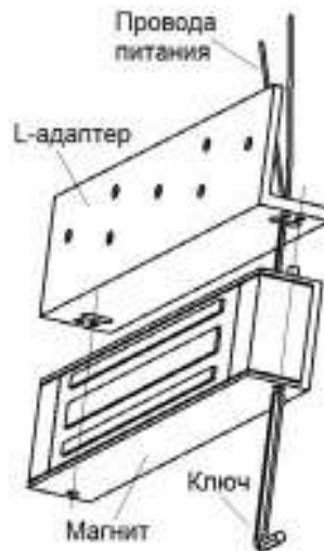
Рисунок 1 (слева) – Применение L-адаптера.
