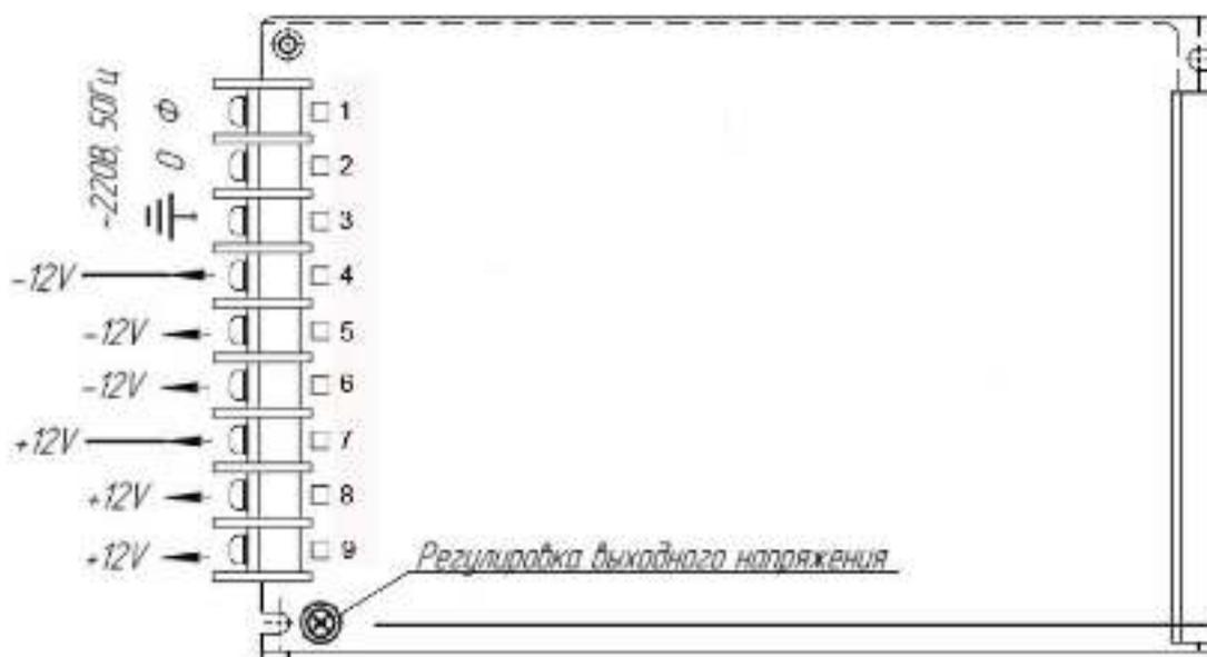
**Внимание!** Несоблюдение полярности подключения может привести к выходу из строя подключаемых устройств.
