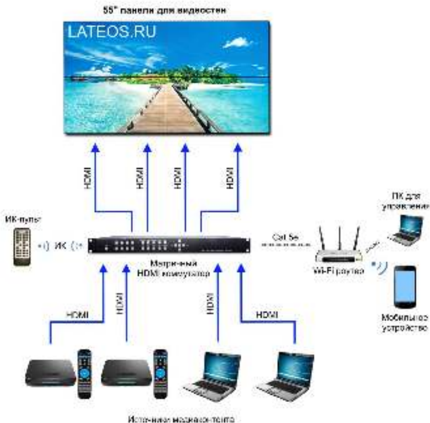
Рис. 3 Схема построения видеостены на базе матричного HDMI коммутатора
