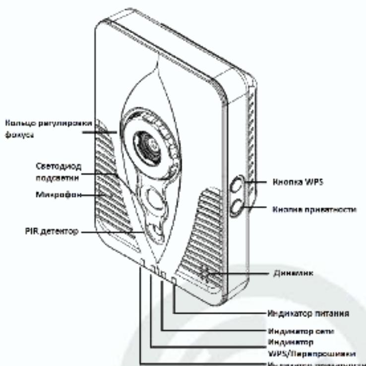
На передней стенке камеры расположено кольцо регулировки фокуса объектива, светодиод подсветки, микрофон, динамик, PIR детектор и индикаторы состояния камеры. Индикаторы показывают наличие питания, наличие подключения к сети, процесс перепрошивки и включения маски приватности.
