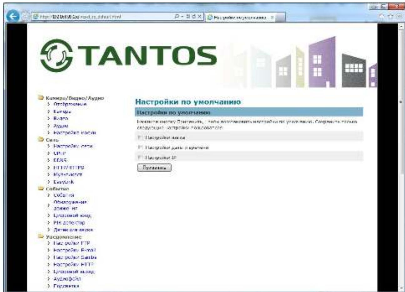
Для возврата камеры на заводские установки нажмите кнопку **Сохранить**. Можно вернуть на заводские все установки, либо оставить заданные сетевые настройки и язык интерфейса камеры.
