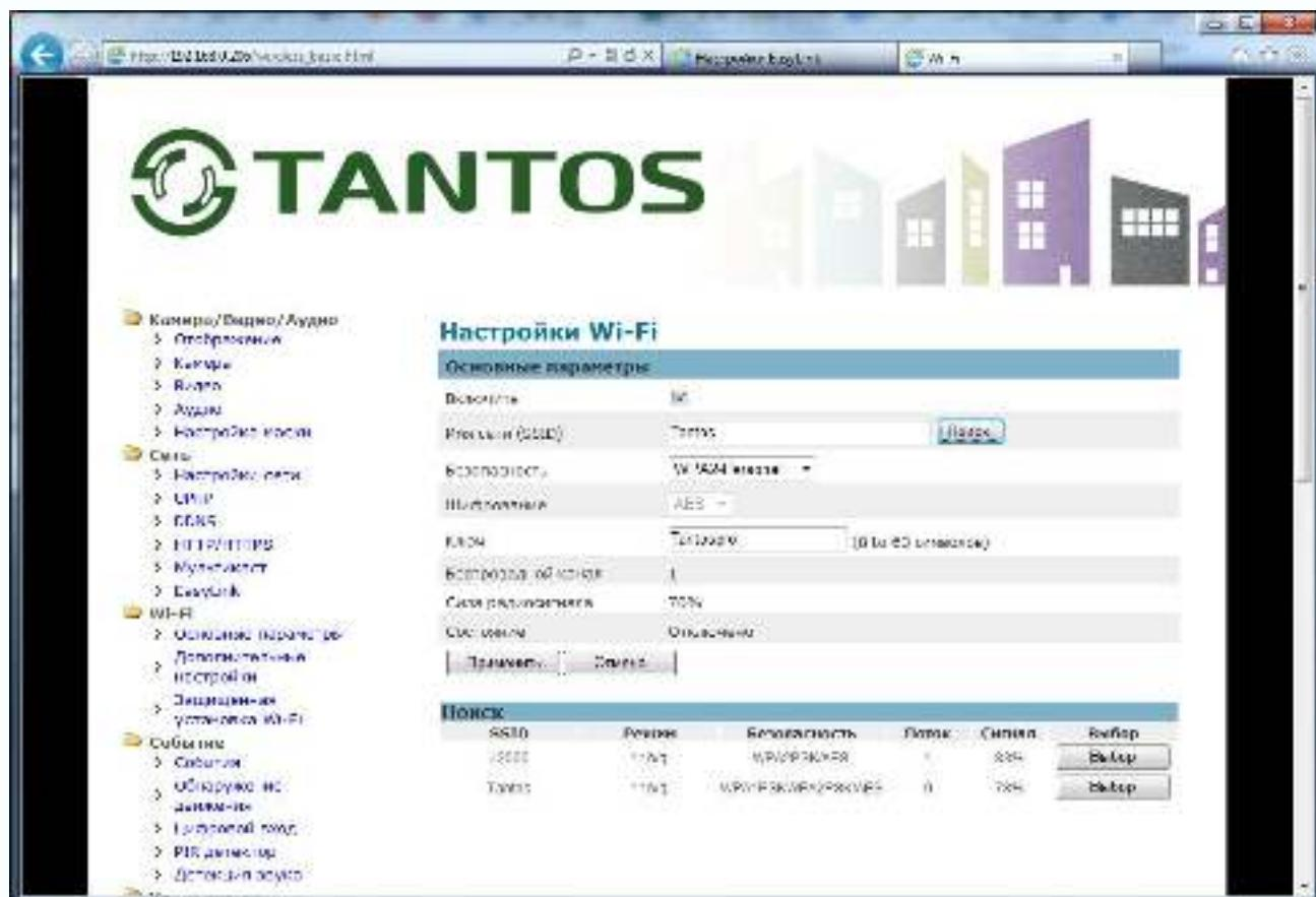
В данном пункте меню производится подключение камеры к беспроводной Wi-Fi сети.
