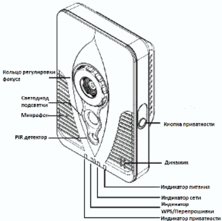
На передней стенке камеры расположено кольцо регулировки фокуса объектива, светодиод подсветки, микрофон, динамик, PIR детектор и индикаторы состояния камеры. Индикаторы показывают наличие питания, наличие подключения к сети, процесс перепрограммки и включения маски приватности.
