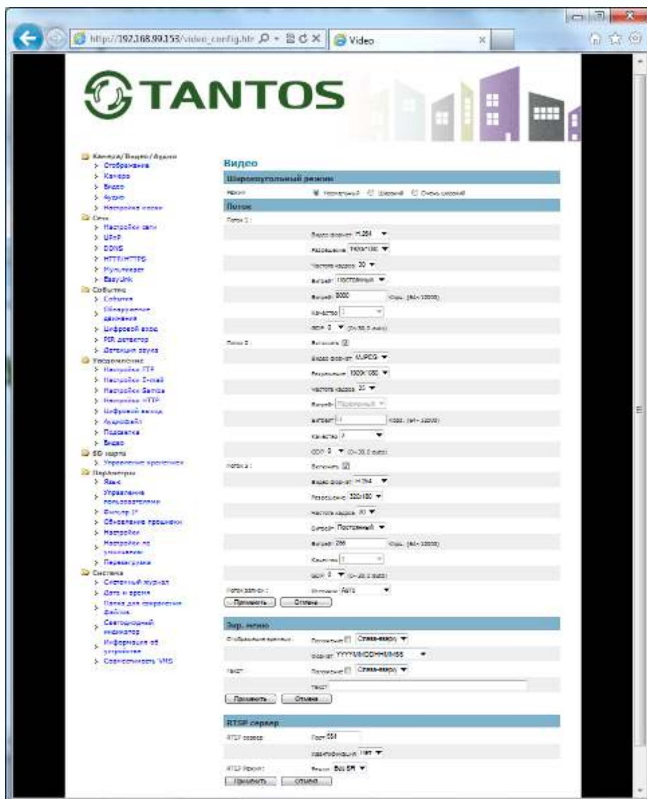
В данном меню производится настройка видеопотоков камеры. Камера может транслировать три независимых потока, каждый из которых имеет независимые настройки. Каждый из видеопотоков может использоваться для вывода на монитор и для записи. Данная особенность камер позволяет, например, записывать видеопоток 1 с максимальным
