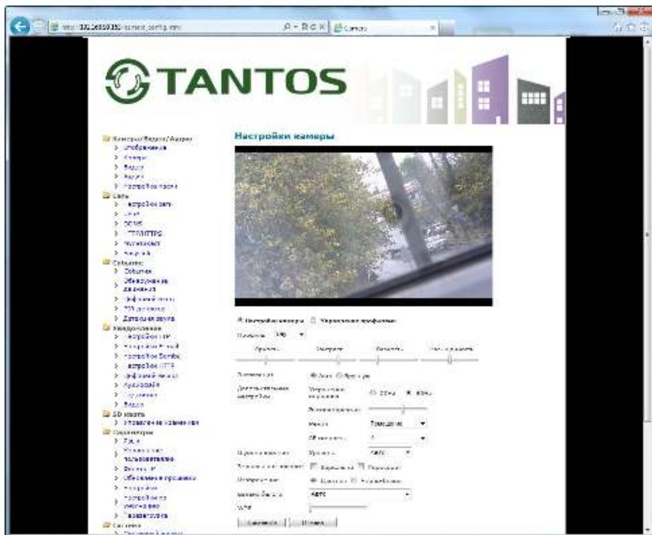
В данном меню осуществляется настройка светочувствительной матрицы камеры. Камера имеет пять профилей настройки светочувствительной матрицы, между которыми можно переключаться. День, Ночь и Закат - это стандартные профили. Могут быть добавлены еще 2 дополнительных профиля.
