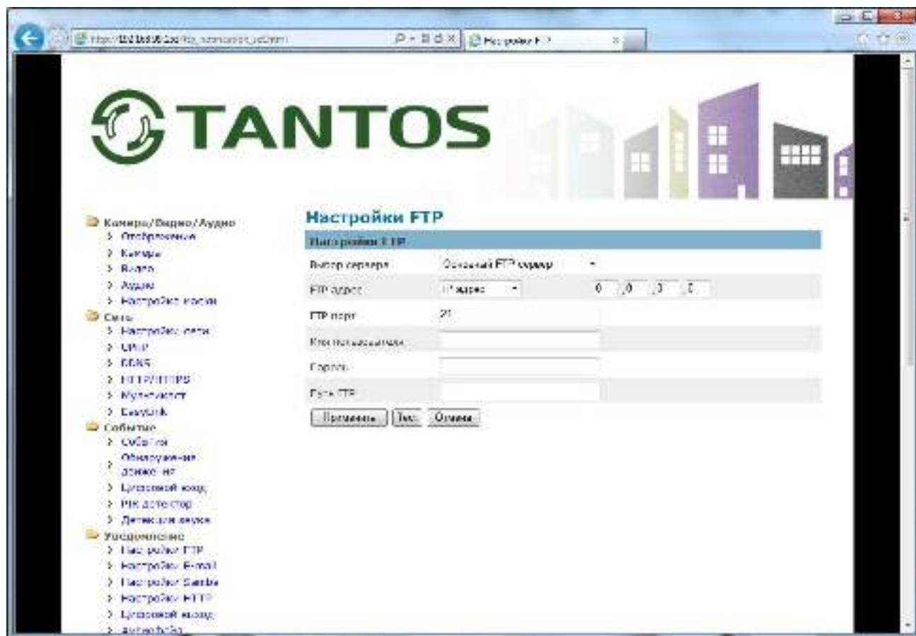
Камера поддерживает два независимых FTP сервера с различными настройками.
