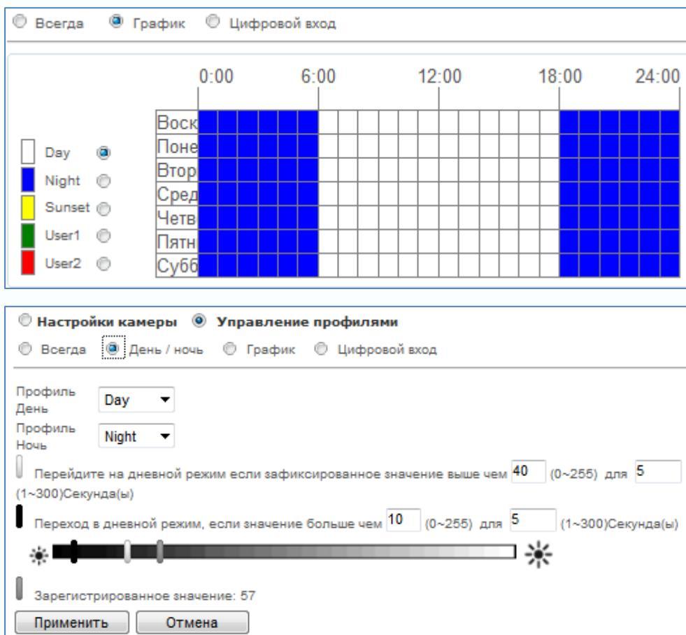
Для каждого профиля контроль экспозиции может быть автоматический «Авто» и «Ручной» с временем срабатывания затвора от 1/5 до 1/20000 и усилением от 1 до 32.
