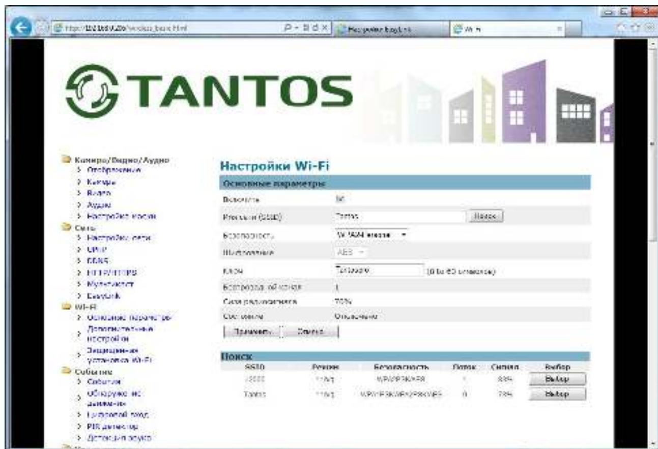
После ввода ключа шифрования нажмите кнопку **Применить**. Камера покажет текущий беспроводной канал подключения **Беспроводной канал** 13, силу сигнала **беспроводного сигнала** 94% и статус подключения.
