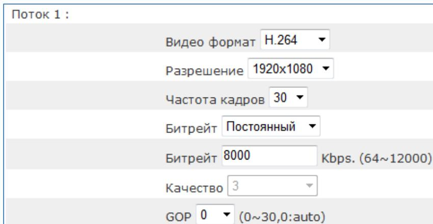
**Кодек** – формат кодирования видеосигнала для текущего видеопотока.
