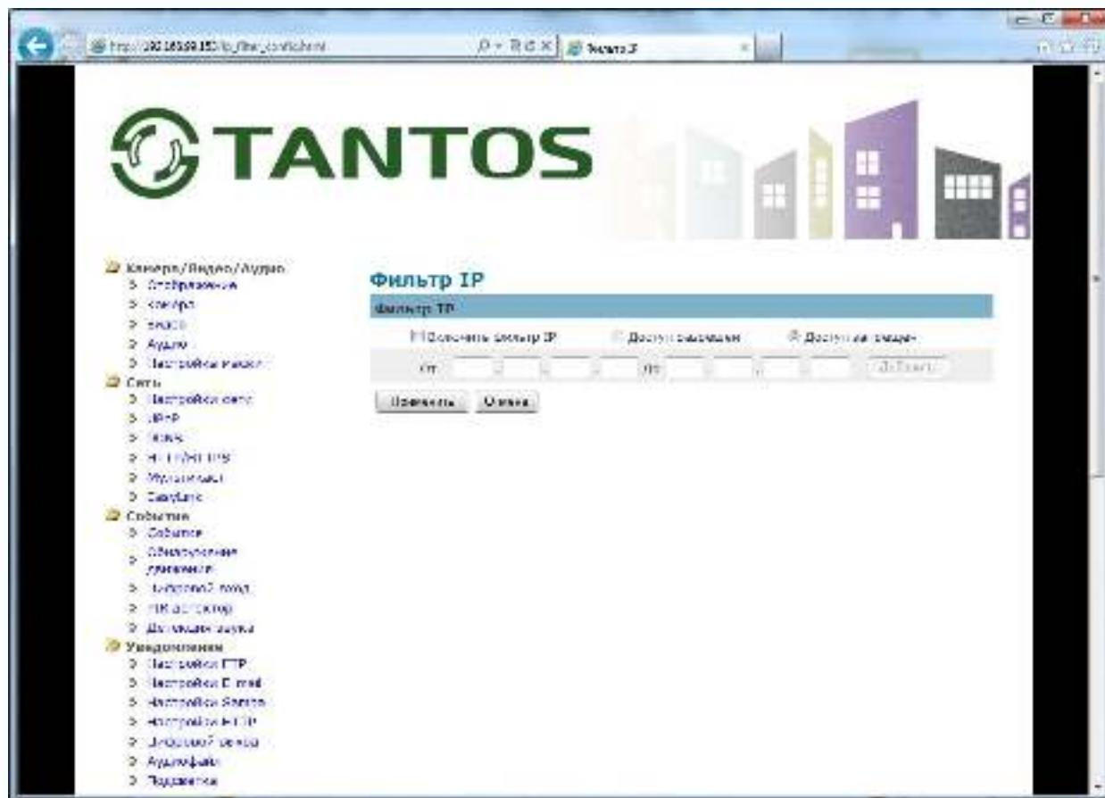
**Доступ разрешен** - диапазон IP адресов, с которых разрешен доступ к IP камере.
