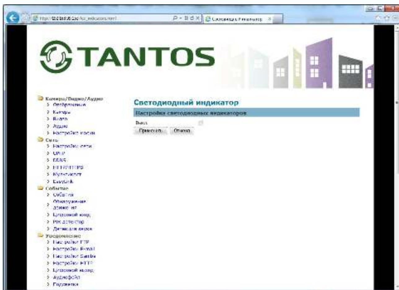
В этом пункте меню настраивается включение и отключение индикаторных светодиодов камеры. Если в данном пункте меню установлено **Выкл**, то при включении и работе камеры индикаторы питания и сетевой активности загораться не будут. Это полезно использовать для того, чтобы злоумышленник не мог определить, включена или отключена камера.
