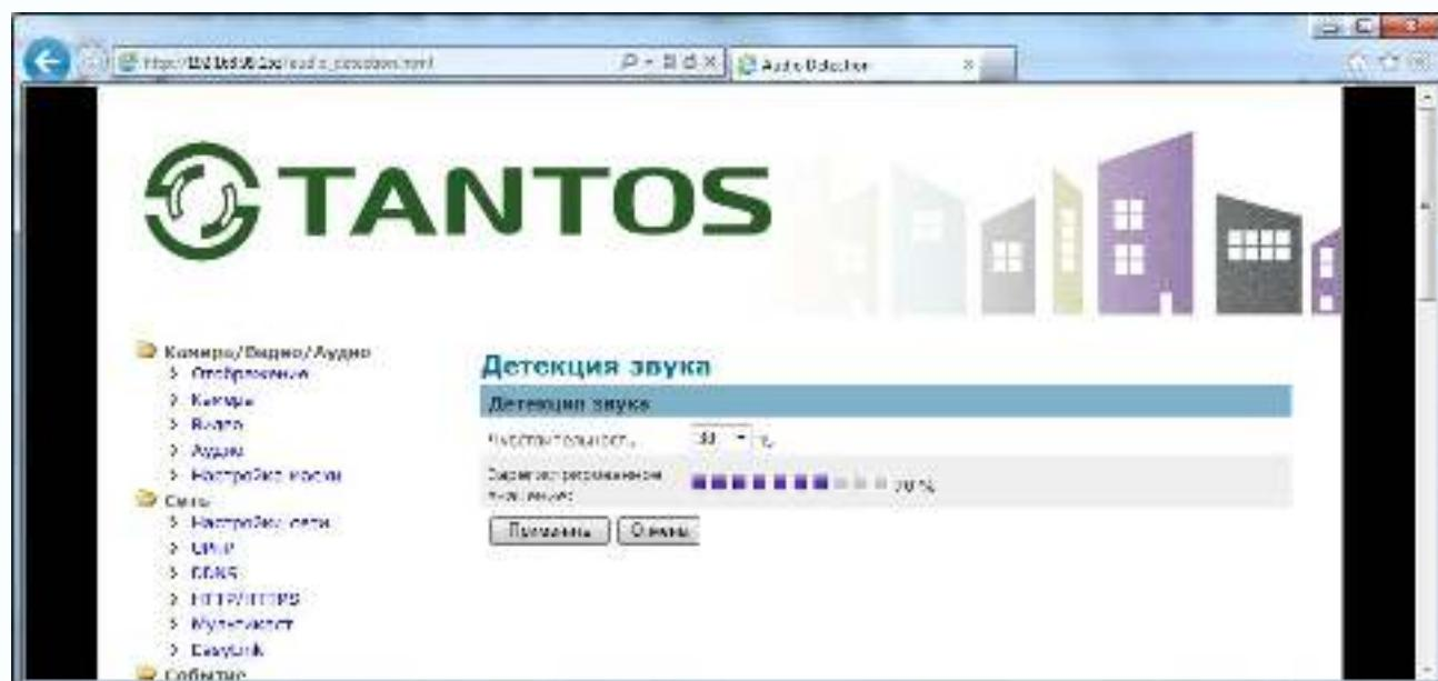
**Чувствительность** – уровень звукового сигнала, при превышении которого срабатывает детектор звука.
