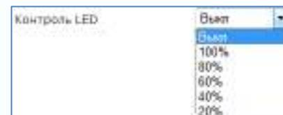
В меню «**Контроль LED**» устанавливается яркость свечения светодиода подсветки.
