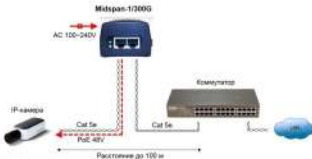
Рис. 3. Схема подключения инжектора Midspan-1/300G
