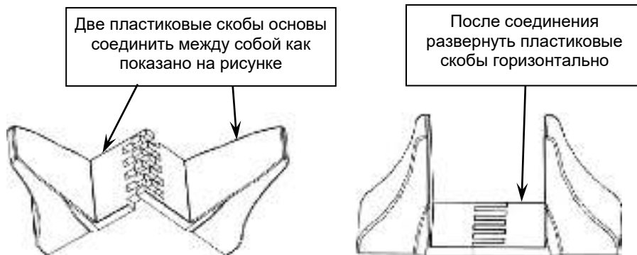
Рисунок 3 - Сборка пластиковых основ для вертикальной установки изделия.
