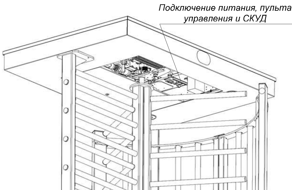
Рис. 15. Расположение кросс-платы на верхнем модуле турникета.
